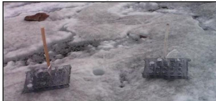
MICROCOSMI POSIZIONATI SUL GHIACCIAIO PER SIMULARE LE CRIOCONITI
