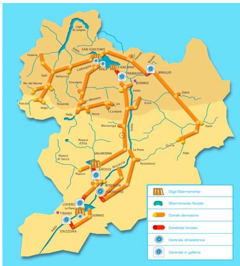
Schema del sistema idroelettrico A2A della Valtellina (Fonte: A2A)
